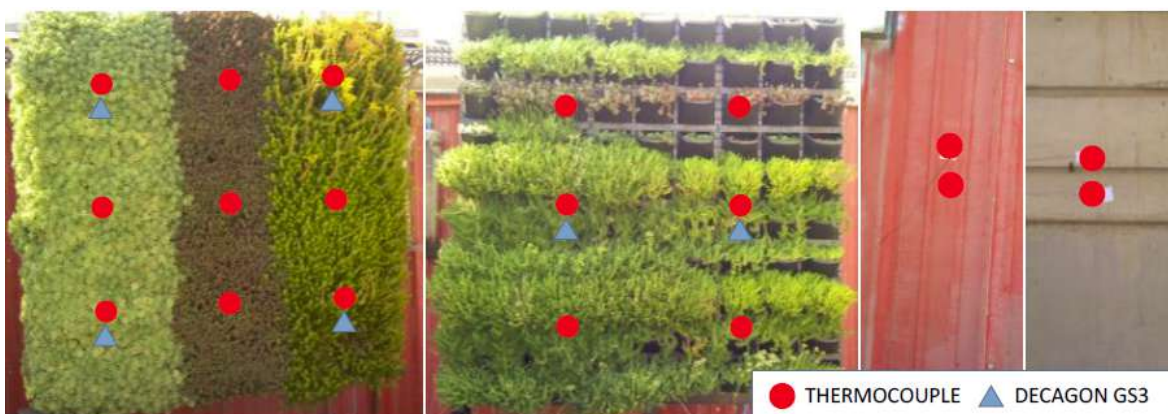
Figura 4.11. Tipologías de muros evaluados (de izquierda a derecha): muro vivo 1, muro vivo 2, muro metálico rojo, muro de hormigón a la vista (Victorero et al., 2015).
