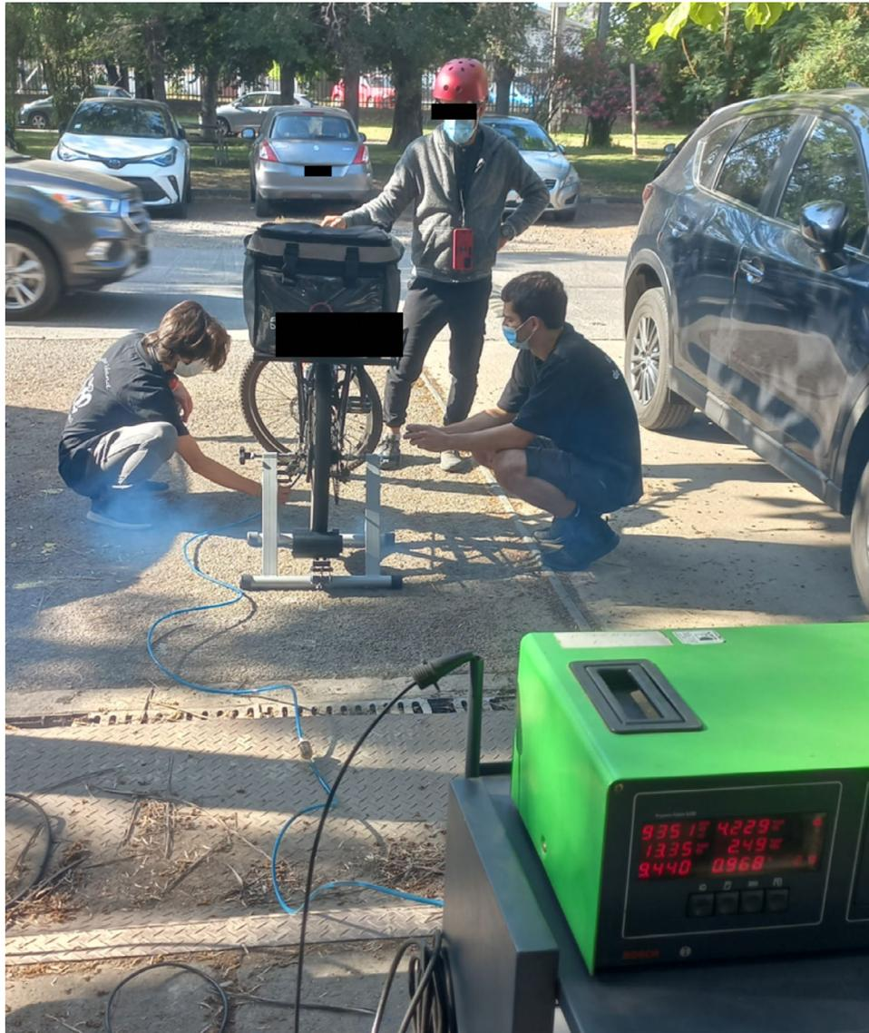
Figura 6: medición de una moto con altas emisiones de HC. Se observa el humo azul y un registro cercano al máximo posible en el equipo (cifra en la esquina superior izquierda).
