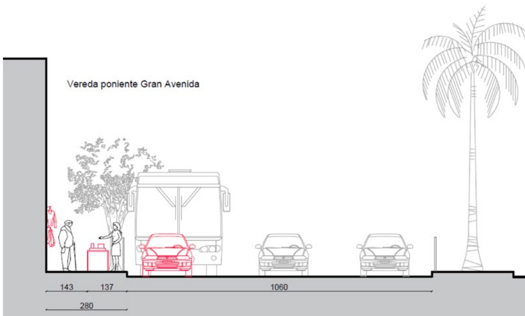
Fig. 9. Detalle Corte Gran Avenida José Miguel Carrera - Elementos que ocupan temporalmente el espacio vial: Objetos del comercio informal en aceras y vehículos en Pista Sólo Bus
