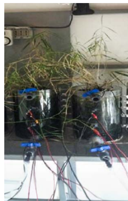
Figura 1: Humedales construidos acoplados a BES como alternativa al tratamiento descentralizado de aguas grises. Montaje experimental junto con esquematización de humedales construidos acoplados a BES (Araneda et al., 2018).
